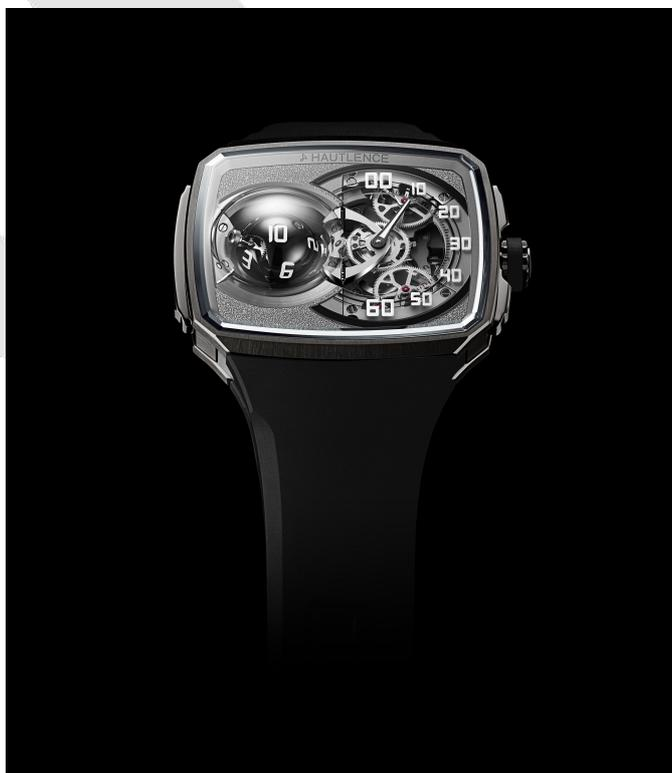
逆跳分钟指针沿着由蓝宝石水晶制成的180度弧形分钟轨道移动，轨道外缘饰以黑色线条。通过分钟轨道开口，可观察到齿轮传动装置，在分针回归零点时减缓分针的运动速度，以减少冲击。在其下方，可以看到触发跳时机制的自由轮及蜗轮凸轮。分钟轨道上的白色镶贴数字由Globolight®制成，这是一种含有Super-LumiNova®夜光物料的创新陶瓷基底材质，在黑暗处散发蓝色光芒。
