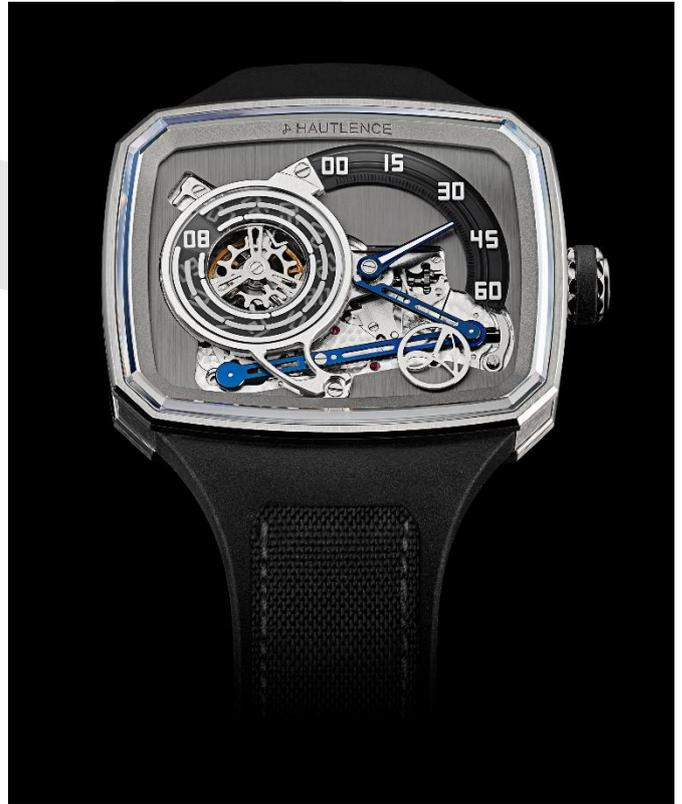
從錶盤側可看見靈感來自火車頭的槓桿系統，將蝸形凸輪與藍鋼逆跳分針及跳時切換機制連接起來，使它們能在每個小時結束時同時前進。取材自豪朗時最新作品，淺色藍寶石水晶的弧形逆跳分鐘軌道採用 Globolight® 製成的鑲貼數字，這是一種注入 SuperLumiNova® 的陶瓷材質，在豪朗時近期包括 Linear 和 Sphere 系列的創作中獲得廣泛應用。最後，HLXX 借鑒 HL2 的設計，以旋轉的莫比烏斯環標誌顯示腕錶正在運行，時間自然而然而流逝。
